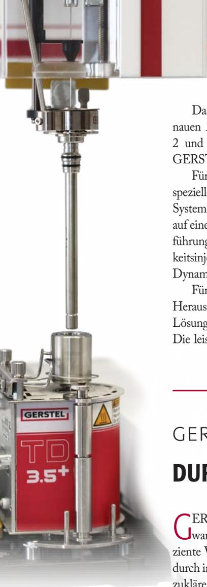
Das TDS 3 verfügt über einen eigenen, passgenauen Autosampler (GERSTEL-TDS A); die TDU 2 und der TD 3.5+ werden mit Autosamplern der GERSTEL-MPS-robotic-Serie kombiniert.
