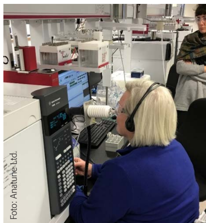
Mithilfe der GC/MS und GC/O versuchen Forscher die für Morbus Parkinson offenkundig charakteristischen Geruchsmarker zu identifizieren. Joy Milne, die Parkinsonkranke am Körpergeruch erkennen kann, unterstützt die Forscher am GERSTEL-ODP im Labor des britischen GERSTEL-Partners Anatune.
