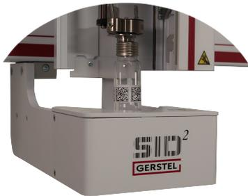
Die Option SID 2 ist eine Option für die GERSTEL-Multi-PurposeSampler MPS Robotic, MPS Robotic Pro und MPS Liquid. Sie ist ein universeller Laborbedarf. Sie ermöglicht das automatisierte Lesen von ein- und zweidimensionalen Barcodes auf Vials und TD-Röhrchen als Teil der automatisierten Probenvorbereitung.
